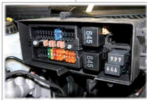
Sicherungs- und Relaisträger, im Vorderwagen, links unterhalb der Windschutzscheibe
